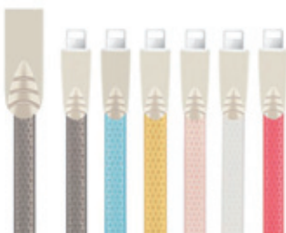
CAVO USB - 8 POLI PER iPhone GUAINA TPE MT 1 Cavo USB-iPhone per ricarica e scambio dati. Connettori USB maschio – 8 poli Maschio, lunghezza mt 1, compatibile con alimentatori quick charge, ricarica fino a 2A
